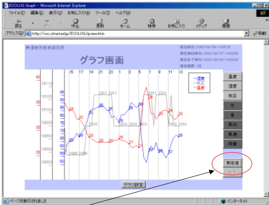
測定値のトグルボタンが、ON の状態で横軸の間隔でグラフ上に測定値が表示される。
